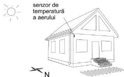
Imaginea 1. Amplasarea senzorului de temperatură a aerului
